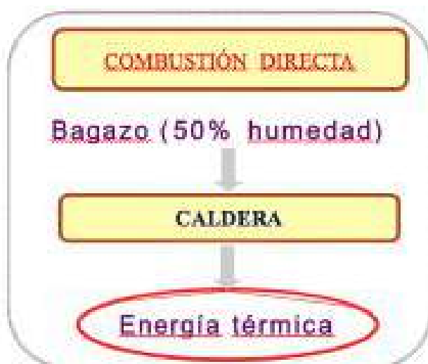
Figura 1. Esquema de la combustión del bagazo para producción de energía térmica
