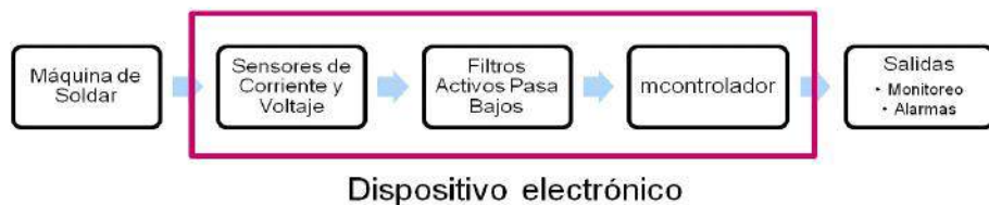
Figura 4. Estructura del dispositivo electrónico para el monitoreo y control del stick out
