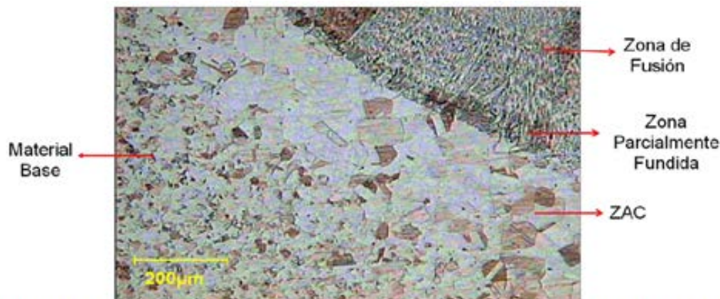
Figura 2. Micrografía (MO) de la soldadura con Electrodo Revestido que muestra las estructuras de la zona de fusión, la zona parcialmente fundida, la zona afectada por el calor (ZAC) y el material base. Muestra atacada con agua regia.
