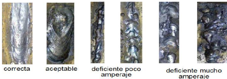
Figura 3. Calidad de soldaduras dependiendo de la intensidad eléctrica
